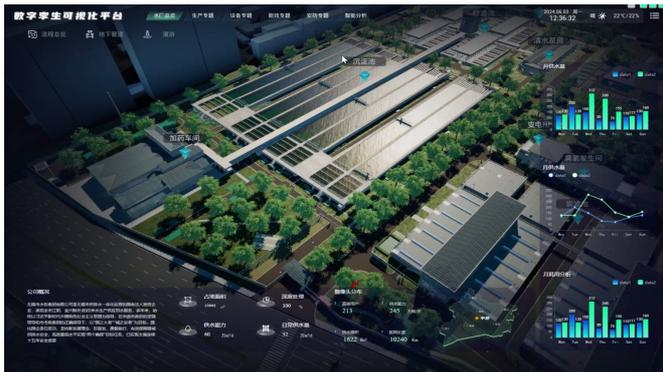
中桥水厂始建于上世纪80年代，09年开始老水厂改造；在这几十年中水厂做了信息化、自动化的改造，但由于改造的时间、厂家等等因素导致一个业务有几个不同的平台分别进行运维管理，加大了工作的繁琐程度。在以提高工作效率和数据利用已经少人化值守为目的大背景下，构建了中桥数字孪生系统平台，这座虚拟水厂深入构建了中桥
