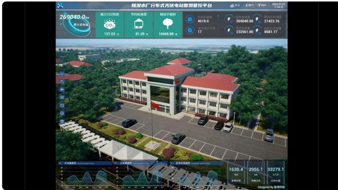
锡澄水厂绿色水厂是当前水厂升级的一个方向，锡澄水厂于22年开始进行绿色新能源改造，全场搭建了4.6MWp的分布式光伏发电站，但是其业务体系与水厂自身并不相同容，电站运行情况也不直观，搭建“元宇宙”水厂+光伏数字化监控系统，以“数字孪生”技术还原真实场景，通过三维可视化模式有效实现电站运行的智慧管理，提高工作效率；
